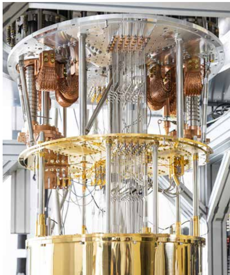
Kryogener Aufbau und Ansteuerung eines supraleitenden Quantencomputers am Forschungszentrum Jülich
