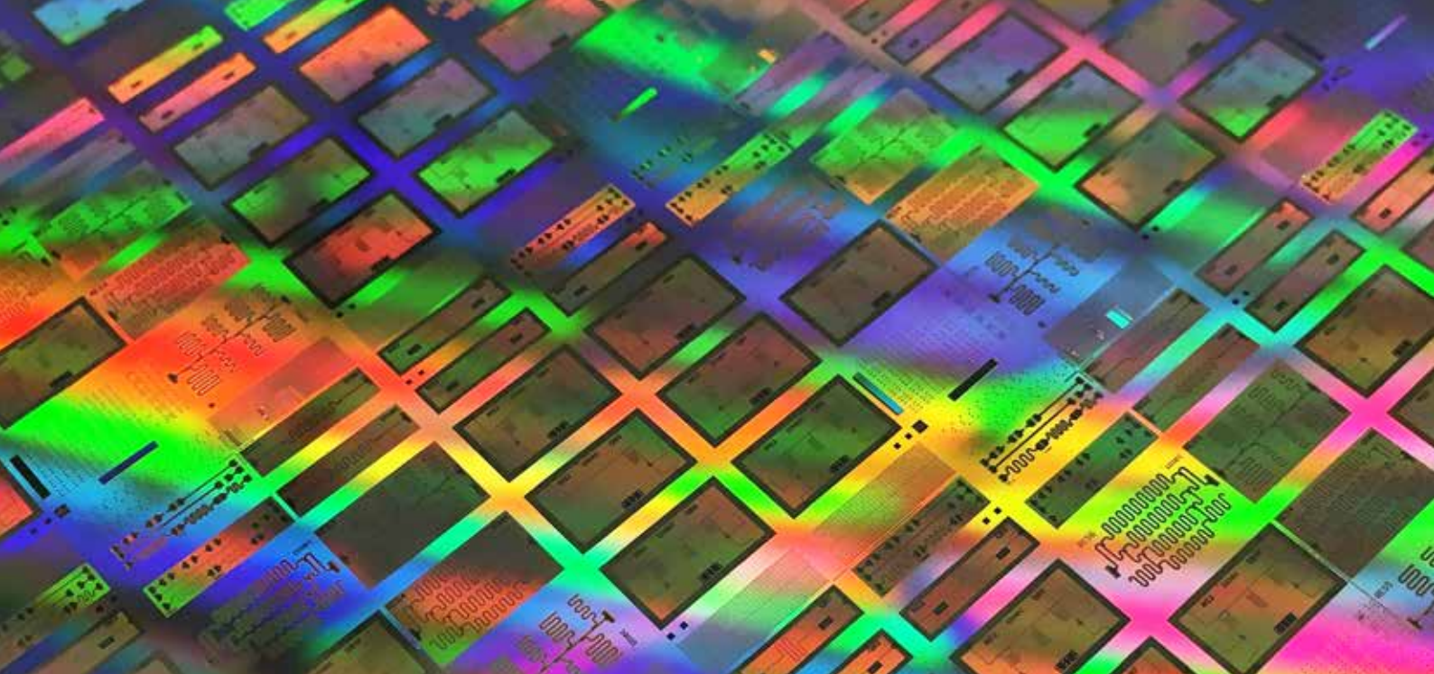
Testchip mit supraleitenden Qubits auf Basis von 300-mm-Wafertechnologie
