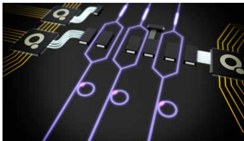
Grafische Darstellung eines photonischen Quantencomputers mit Ringresonatoren als Quantenlichtquellen (violette Kreise), Wellenleitern (violette Linien), elektrisch modulierbaren Mach-Zehnder-Interferometern (Rauten) sowie elektrischen Kontakten (schwarze Kästchen), Chipsteuerung (schwarze ICs mit dem Q-Logo) und Verdrahtung (goldene und weiße Linien).
